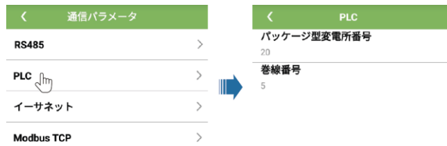
図 7-13 PLC 通信パラメータ
